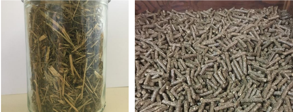
Abbildung 6 & 7: Grasartiges Material muss zur Weiterverarbeitung erst zerkleinert und pelletiert werden
