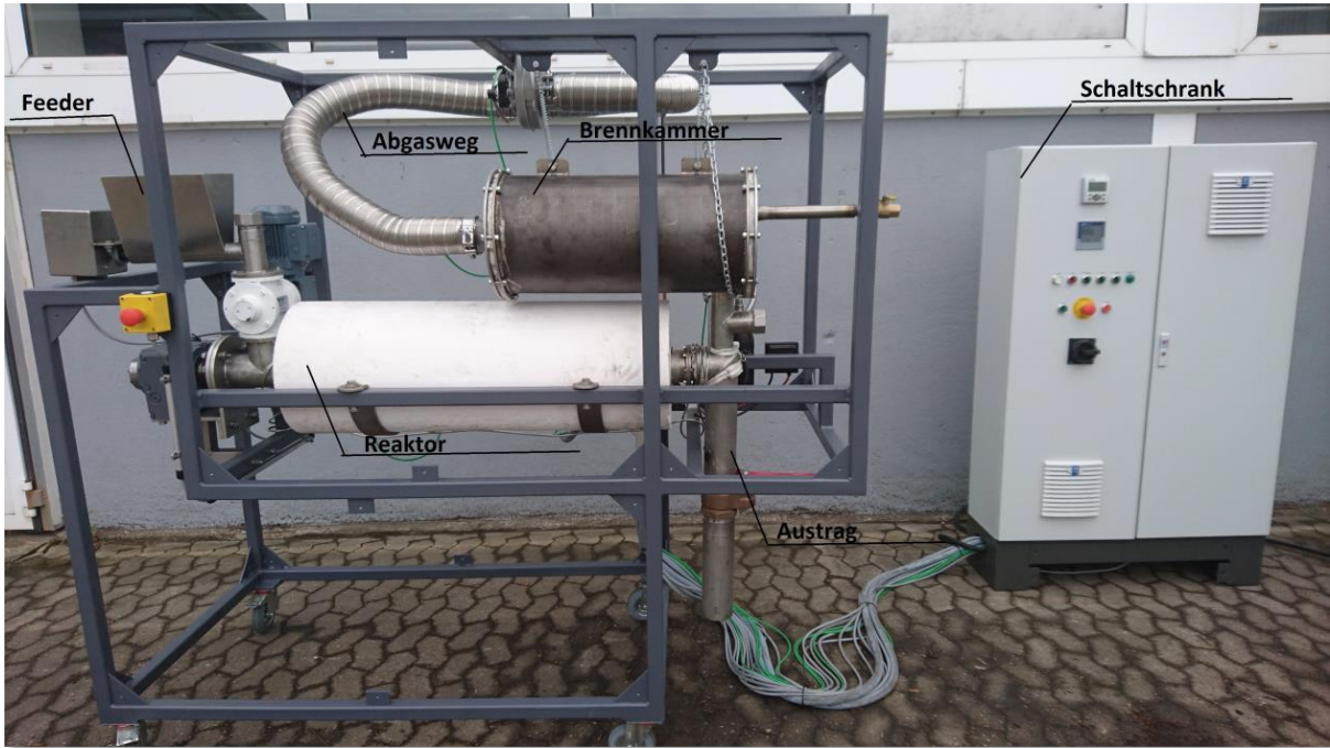
Abbildung 5: Pyrolyse und Aktivierung mittels Laboranlage „Pyreka“ (Bild: Jens Heberling, Pyreg)
