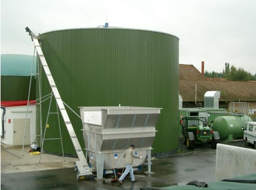
Bild 3: Feststoffeintragstechnik in den Fermenter
